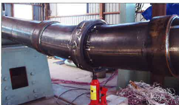
曲げ試験の様子 ●ECS-PJは母材耐力以上であることを確認。
