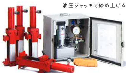
油圧ジャッキで締め上げる
